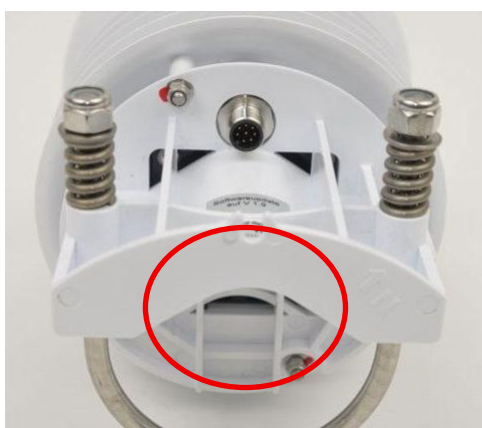
Figura 2. Vista debajo Lufft ws-502 y 700 (posición del ventilador)
