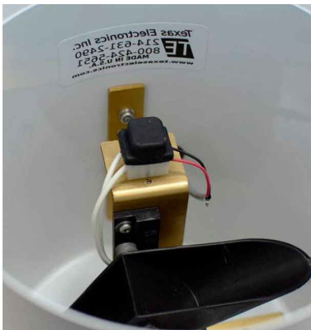
Fotografía 3. Mecanismo de balancín.
